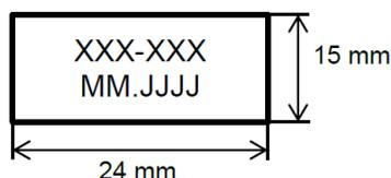
Bei Faltschachteln mit **Blitzboden** ist ein **Aufdruck von MHD/Charge auf dem Boden nicht möglich**. Die variablen Daten müssen auf einer Lasche gedruckt werden.
